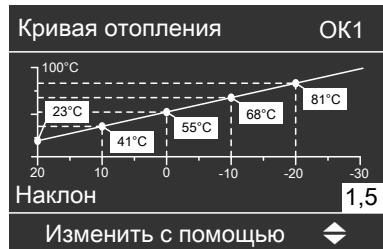
В зависимости от различных значений температуры окружающей среды (изображены по горизонтальной оси) соответствующие заданные значения температуры подачи для отопительного контура изображаются на белом фоне.
